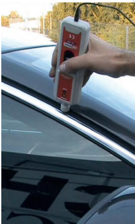
**Aparelho de medição da espessura da camada**
