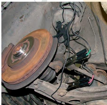
**Estetoscópio de mecânico, eletrónico**
