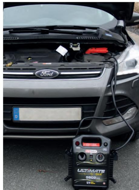
**Booster para baterias de 12 V / 24 V - aparelho auxiliar de arranque portátil 4700 A / 3700 A**
