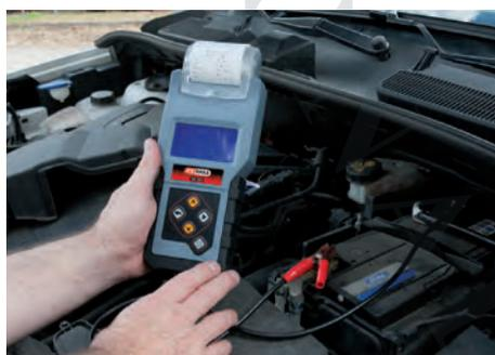
**Aparelho de teste de sistema de carga da bateria digital 12 V / 24 V com impressora integrada**
