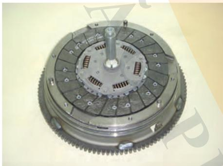
4. Passar o novo disco da embraiagem por cima do equipamento de centragem e aplicar no suporte do volante do motor.
