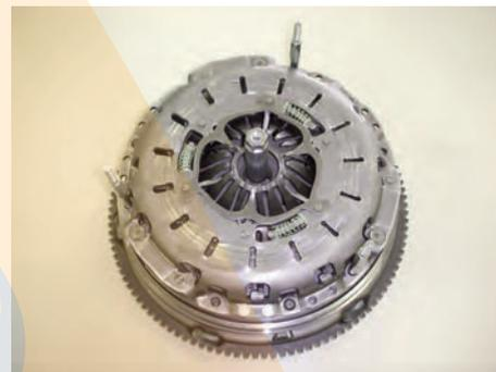
6. Colocar novo prato de embraiagem no volante do motor (ter atenção ao pino de centragem).
