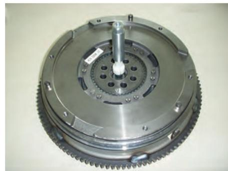
3. Encaixar a cavilha de fixação totalmente equipada (manga de fixação solta) no rolamento piloto.
