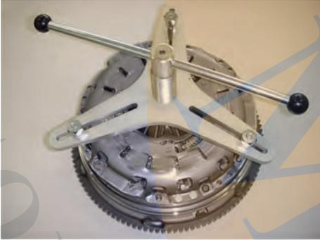
10. Passar dispositivo tensor SAC através dos pernos roscados.
