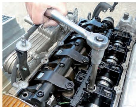
**Kit de pontas de chave de caixa para parafusos da cabeça do motor**
