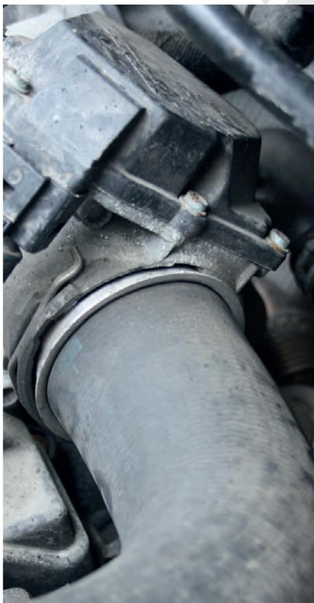
**Adaptador de entrada de ar para sistema de ar de sobrealimentação do turbocompressor com tubo flexível**
