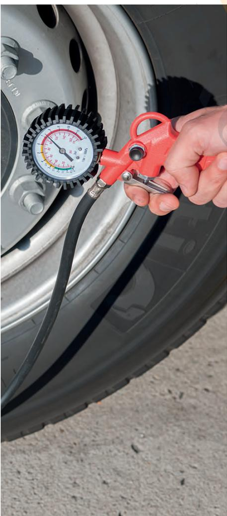
**Manómetro de compressor pneumático**
