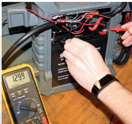
**Multímetro digital incluindo pontas de teste e terminais de crocodilo**
