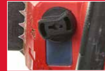
Depósito de óleo antiderrame
