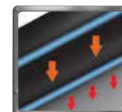
Isolamento melhorado minimiza o peso e aumenta a retenção de calor
